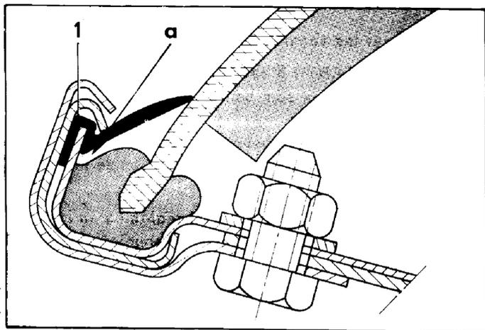
28. A l'aide d'une « lissette », dégager le cordon « SOLBIT » de la bordure du brancard, en « a », afin de permettre le passage du talon du profilé de finition en caoutchouc (1).
