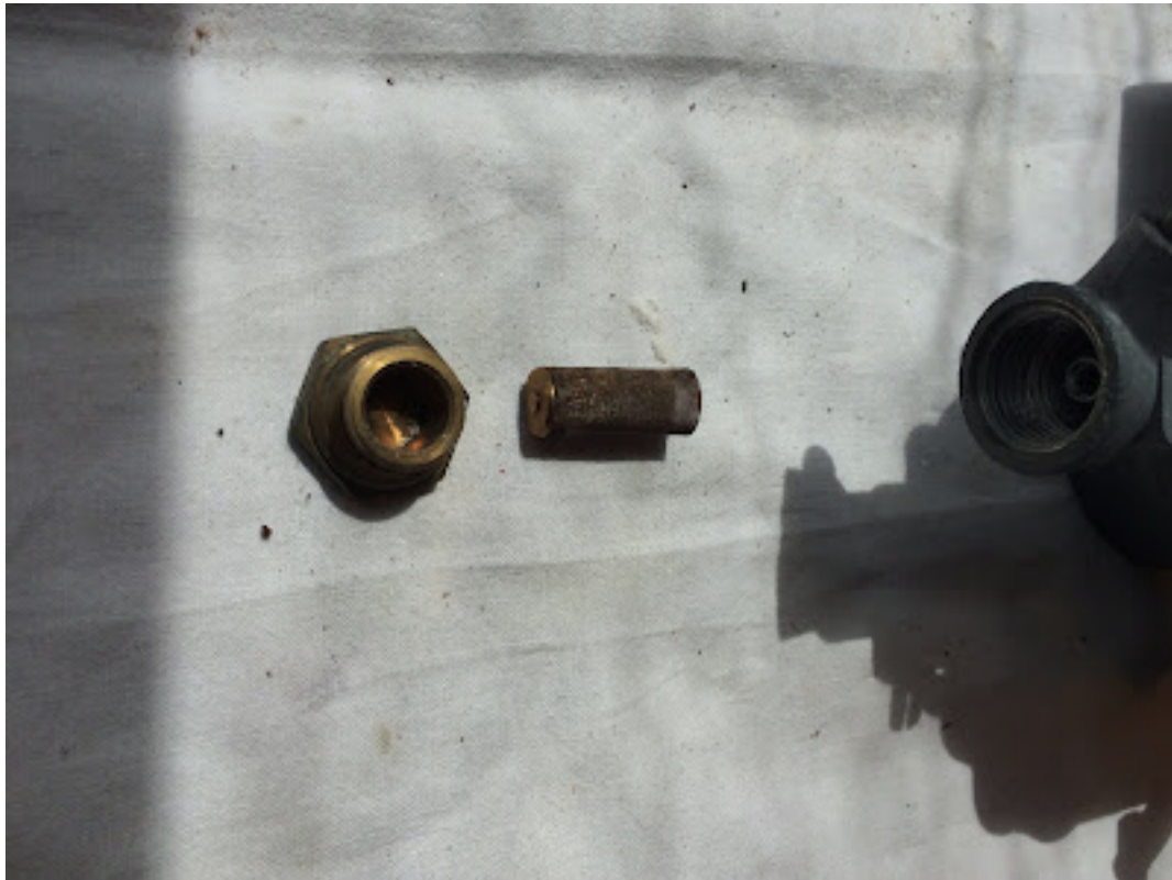
Fil filtre sous le gros écrou en laiton
