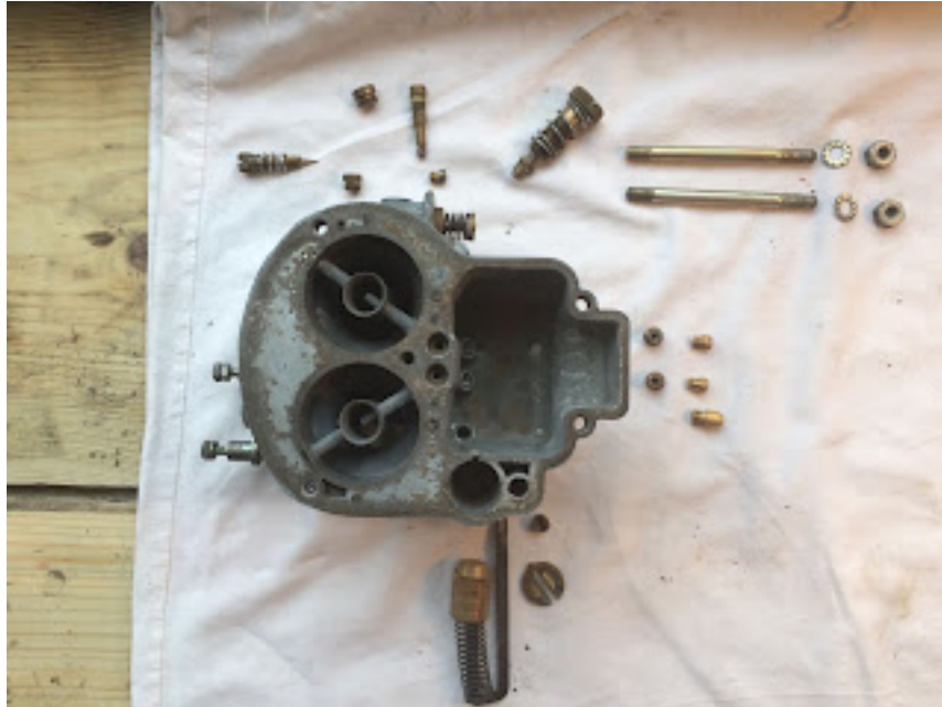
Disposer les pièces de carburateur
