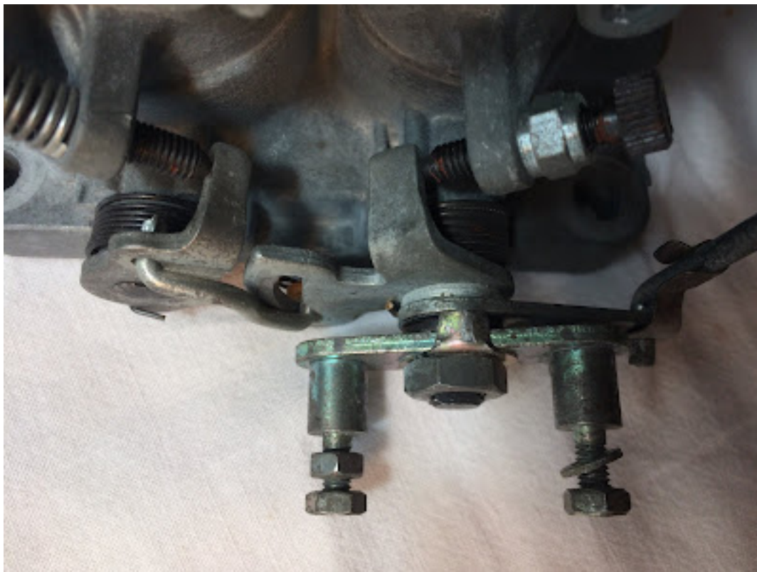
Notez que la rondelle à onglets se plie dans le mauvais sens !
