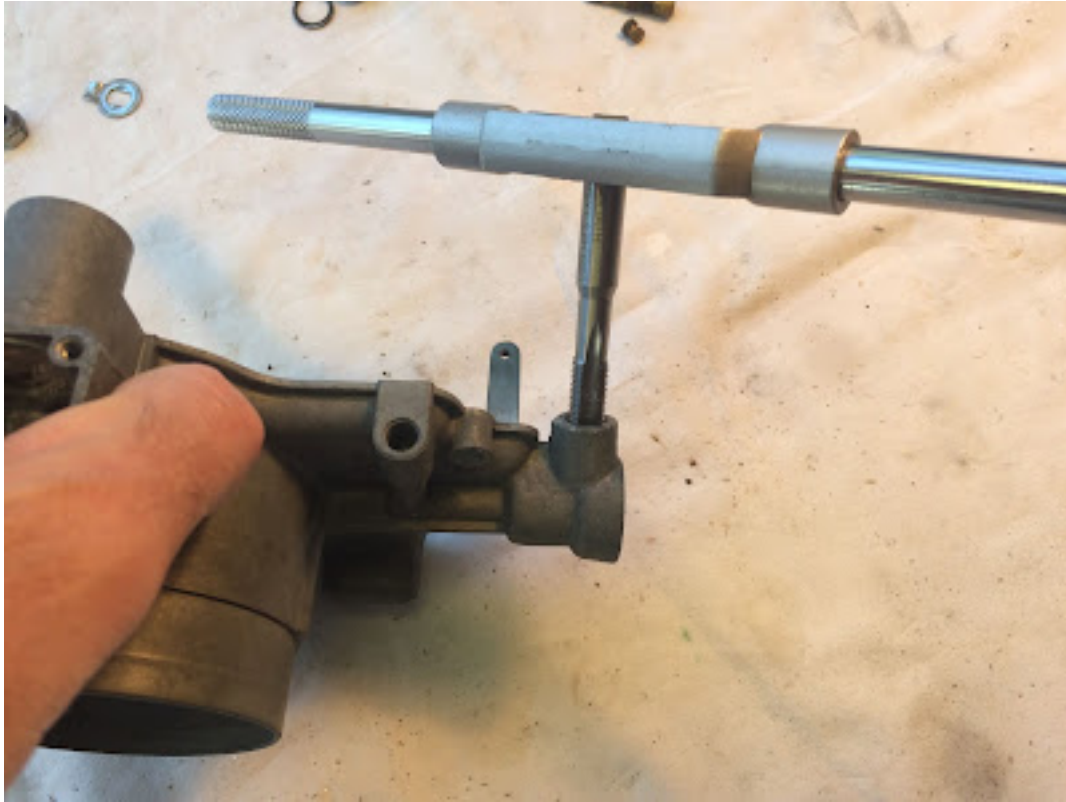
Tapoter le filetage pour une nouvelle entrée de carburant
