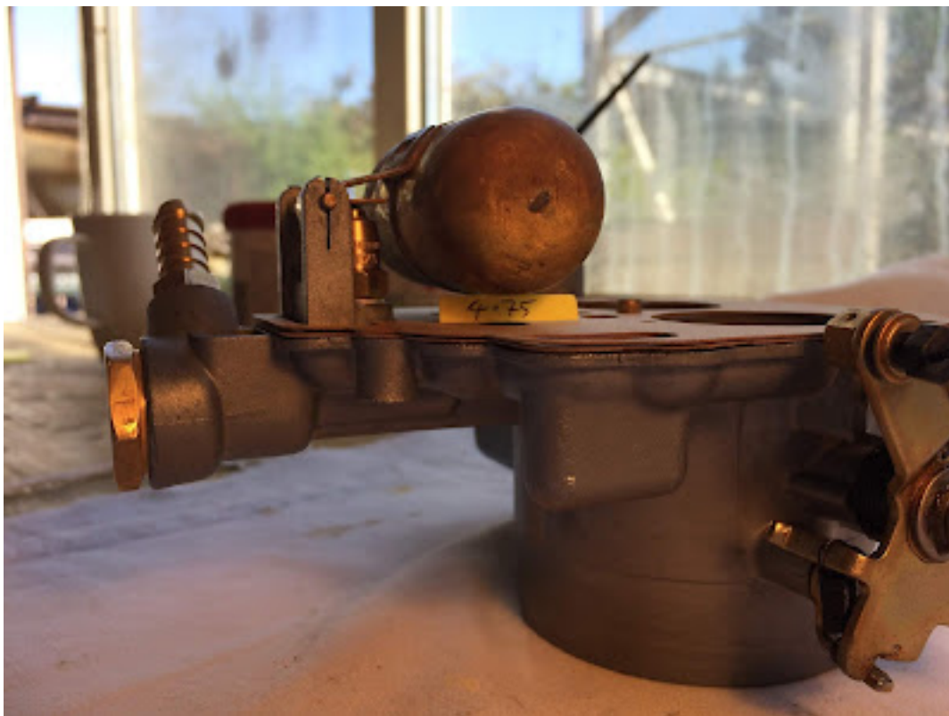
Mesure de la hauteur du flotteur "fermé"
