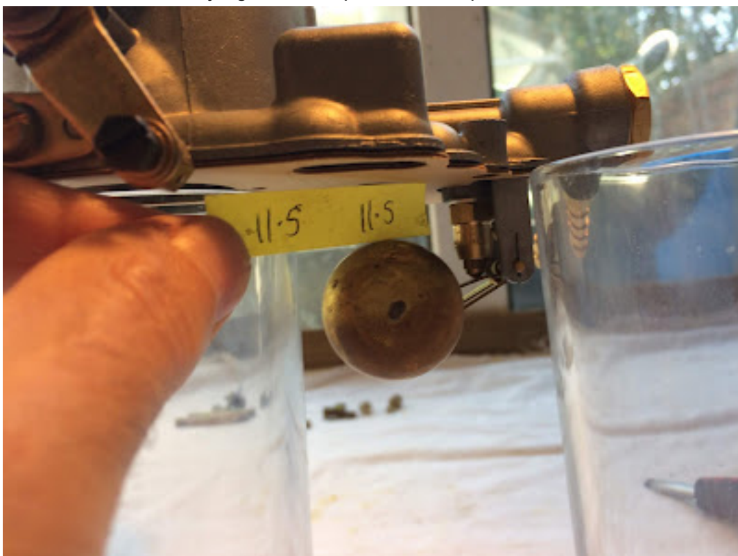
Mesure de la hauteur "ouverte" du flotteur
