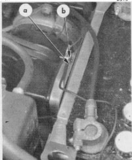
Emplacement des cinq masses sur le véhicule Die fünf Masseanschlüsse am Fahrzeug Positions of the five earth leads on the vehicle Emplazamiento de las cinco masas sobre el vehículo Ubicazione delle cinque masse sul veicolo
