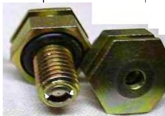
Le but était seulement au début de recharger ma sphère d'accum de frein ! (La pression d'Azote étant nulle et du liquide LHM coulant de l'orifice de la valve le changement de membrane était obligatoire ainsi que le regonflage de celle ci !)
