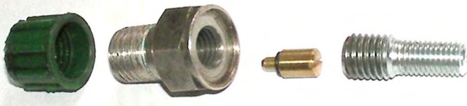
Finalement il m'a paru plus simple de « reconstruire » un outil similaire à ceux utilisé par les concessionnaires Citroën. Cela me parut plus simple et plus authentique. Je garde ainsi le bouchon d'origine avec la pression de tarage poinçonné sur celui ci...
