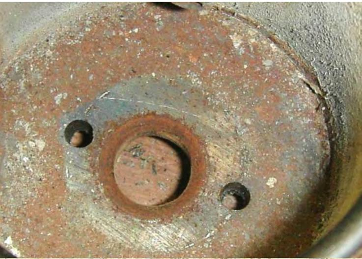
Pour obtenir un joint étanche à ce niveau j'ai créé un chanfrein. Cela permet au joint de venir se placer et plus il veut sortir sous l'effet de la pression plus il rend l'ensemble étanche. Une grosse rondelle le tient en place. Celle-ci est tenue par 2 boulons qui devraient aussi permettre de compresser le joint pour une meilleure étanchéité.
