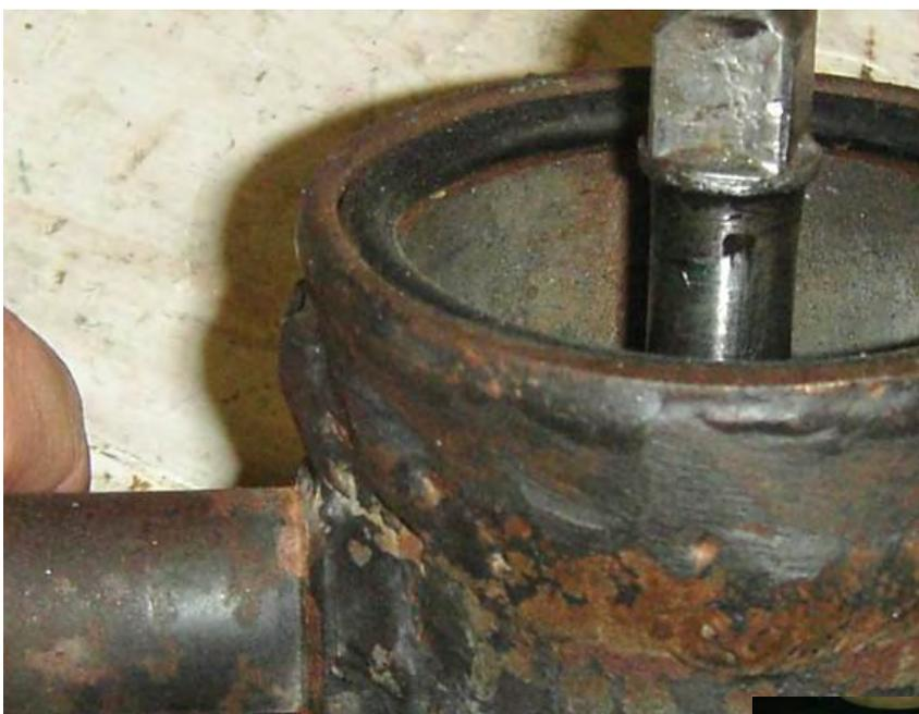
Pour tenir la sphère appuyée, sur la partie « haute » de mon outil, se trouve dans la partie basse une plaque. La sphère est sandwichée entre les deux par 4 gros boulons.
